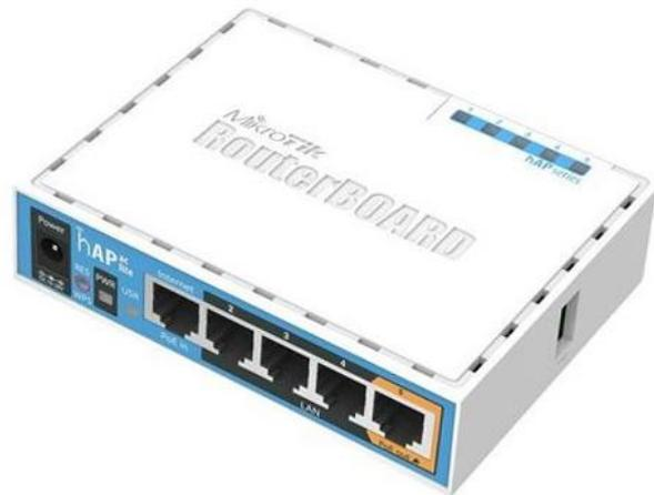
10.2. Устройства позволяют без использования услуг оператора мобильной связи передавать данные на сервер. Так же с их помощью можно организовать систему диспетчеризации в локальной сети предприятия, без выхода в интернет.
